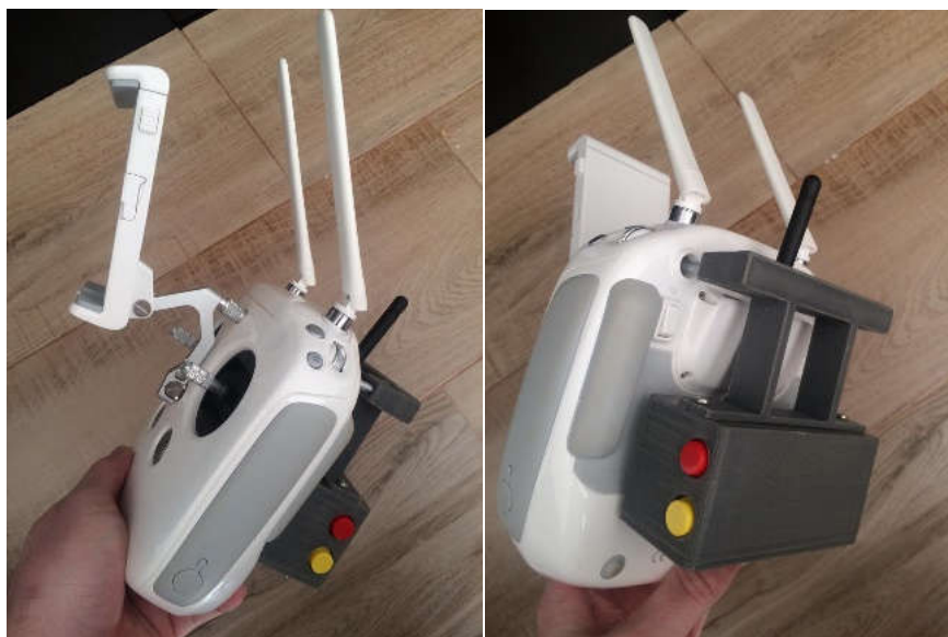
Figura 4. Módulo receptor de dados que se comunica com sensor de temperatura infravermelho acoplado a um VANT para medição de temperatura em viveiros escavados de piscicultura
