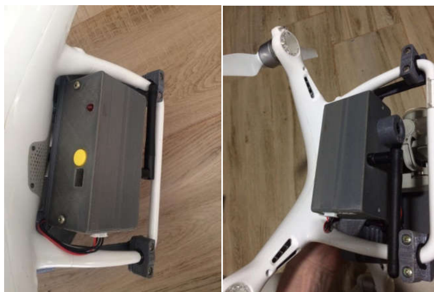
Figura 3. Módulo sensor de temperatura infravermelho acoplado a um VANT para medição de temperatura em viveiros escavados de piscicultura
