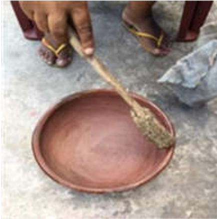
Figura 2. Selagem da peça com jutaica. Foto: Bandeira, 2018
